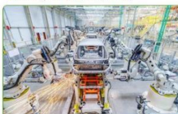
在山西省运城市大运新能源汽车冲焊车间智能化生产流水线，智能焊接机械臂正在进行新能源汽车车架焊接作业
